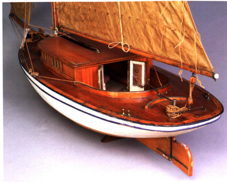
Model van een groot midzwaardjacht uit circa 1860. Opvallend is de brede en ondiepe romp.
